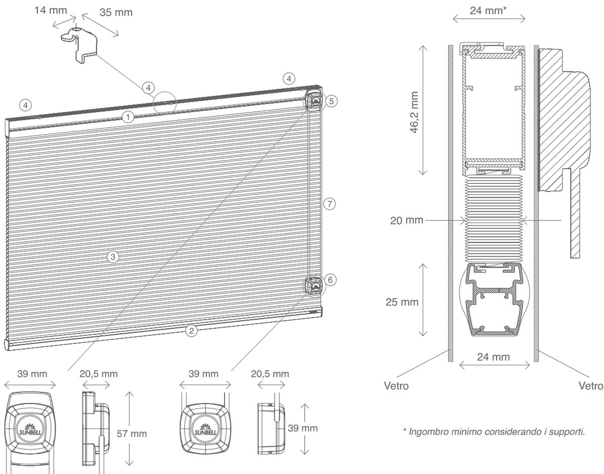
**1. Cassonetto e profilo superiore estrusi in alluminio:** profilati estrusi in lega di alluminio en aw-6060 t5; cassonetto ossidato argento, verniciato bianco in abbinamento a tessuto colore 0201; il profilo superiore di chiusura permette l'uso del supporto a soffitto, posizionabile in qualsiasi punto.
