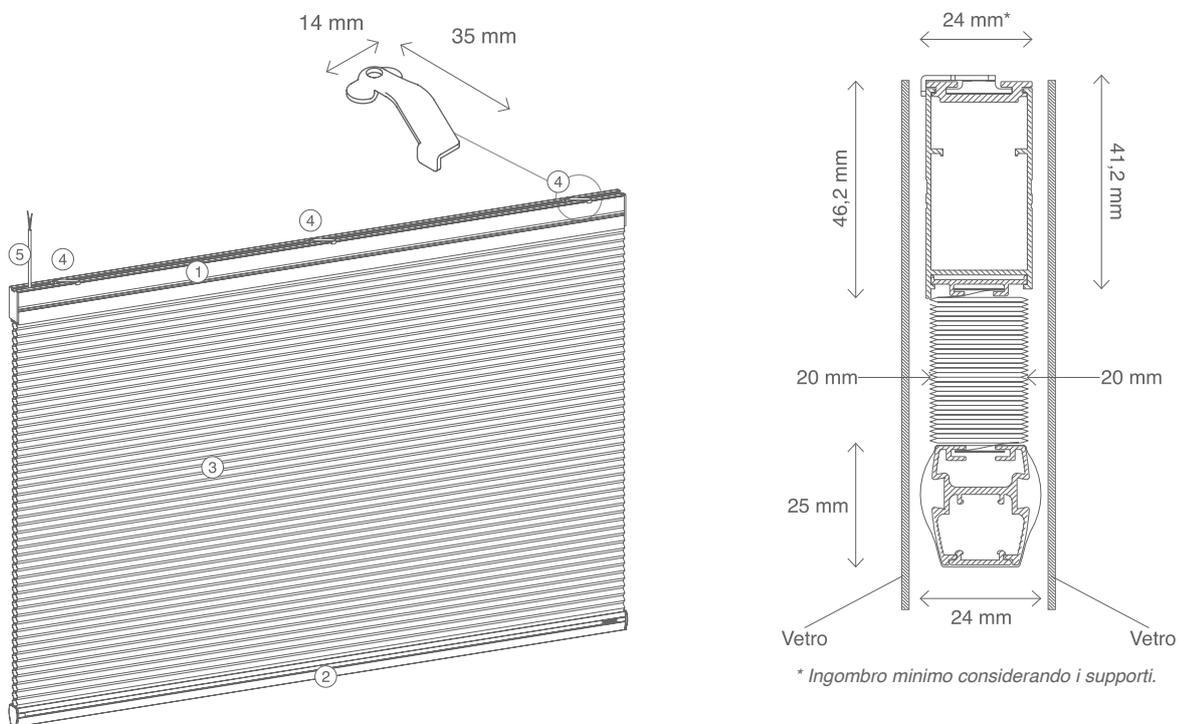
**1. Cassonetto e profilo superiore estrusi in alluminio:** profilati estrusi in lega di alluminio en aw-6060 t5; cassonetto ossidato argento, verniciato bianco in abbinamento a tessuto colore 0201; il profilo superiore di chiusura permette l'uso del supporto a soffitto, posizionabile in qualsiasi punto.
