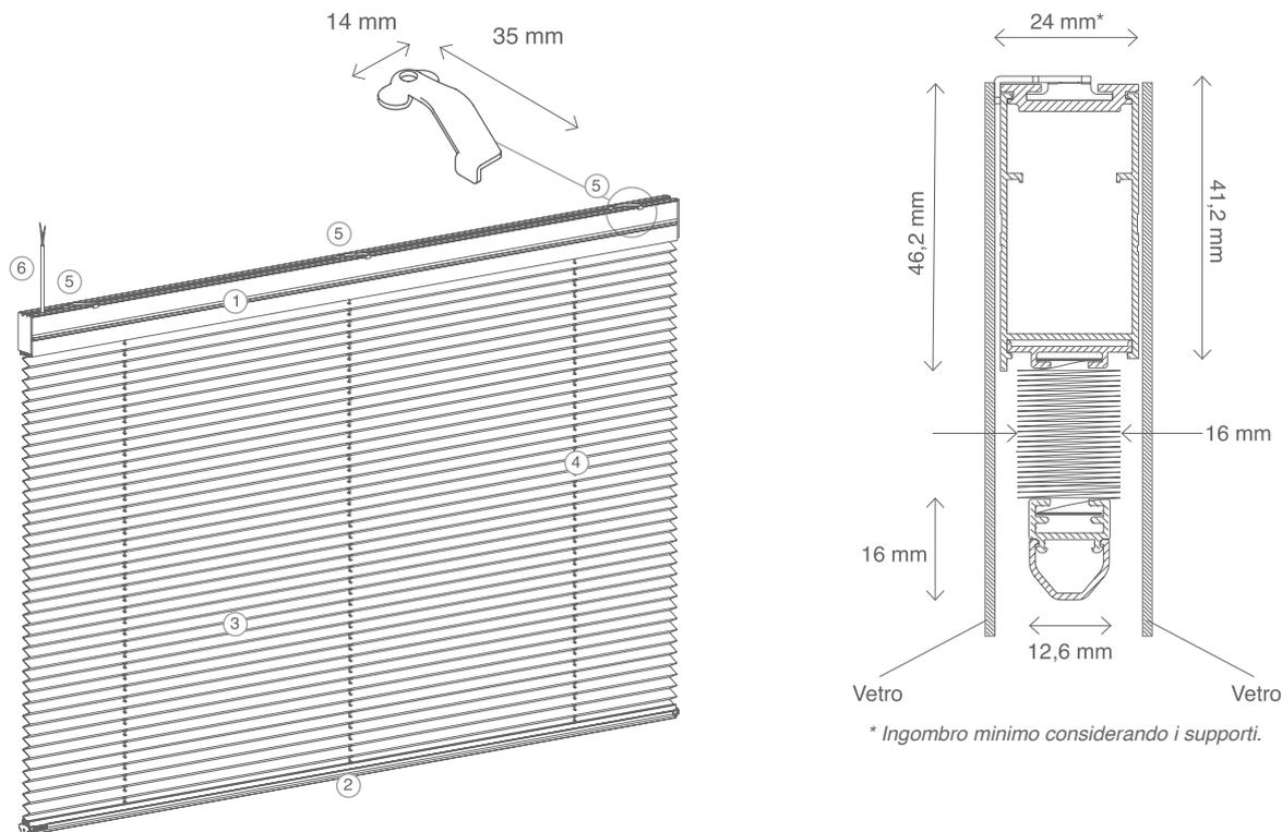
**1. Cassonetto e profilo superiore estrusi in alluminio:** profilati estrusi in lega di alluminio en aw-6060 t5; ossidato argento, verniciato bianco in abbinamento a tessuto colore 000; il profilo superiore di chiusura permette l'uso del supporto a soffitto, posizionabile in qualsiasi punto.
