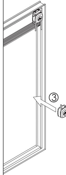
③ Incollare il tensionatore sul vetro utilizzando l'adesivo. Il tensionatore deve essere allineato con il comando superiore.
