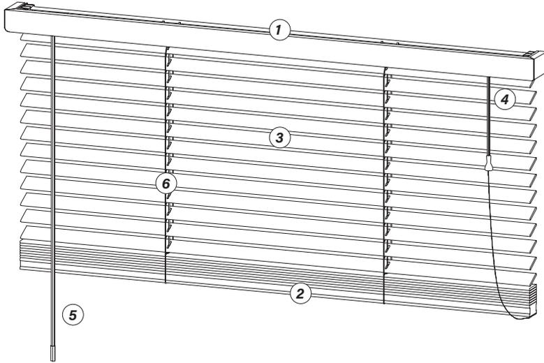
1. Profilo superiore in acciaio inox rullato a freddo e laccato, di dimensioni 27 x 19 mm, (vedere abbinamento colori).
