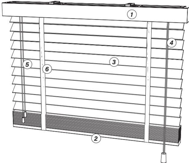
1. Profilo superiore cassetto estruso in lega alluminio en aw-6060 t5 mis. 58 x 52 x sp. 1 mm verniciato a polvere in abbinamento tinte lamelle come da campionario, munito di appositi tappi laterali di chiusura con logo stampati a disegno. Copertura mantovana liscia in legno in tinta con colori lamelle.
