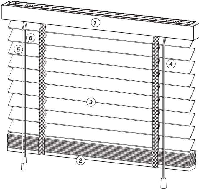
1. Profilo superiore cassonetto estruso in lega alluminio en aw-6060 t5 mis. 58 x 52 x sp. 1 mm verniciato a polvere in abbinamento tinte lamelle come da campionario, munito di appositi tappi laterali di chiusura con logo stampati a disegno. Copertura mantovana liscia in legno in tinta con colori lamelle.
